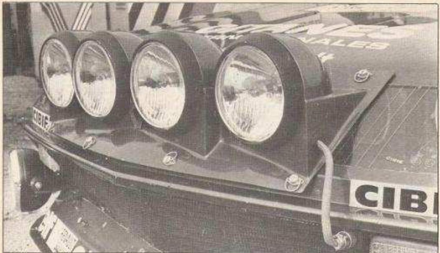
De nombreux éléments modifient la carrosserie tels la rampe de phares amovible, les grosses ailes, le spoiler et l'aile arrière.
